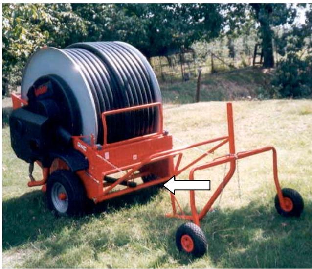
**9.** Durante l'irrigazione il Leader 50 riavvolge completamente il tubo. Il contatto con il carrello portairrigatore provoca la fine dell'irrigazione. **ATTENZIONE:** la macchina termina l'irrigazione ma non arresta la pompa e non mette a folle il riduttore.
