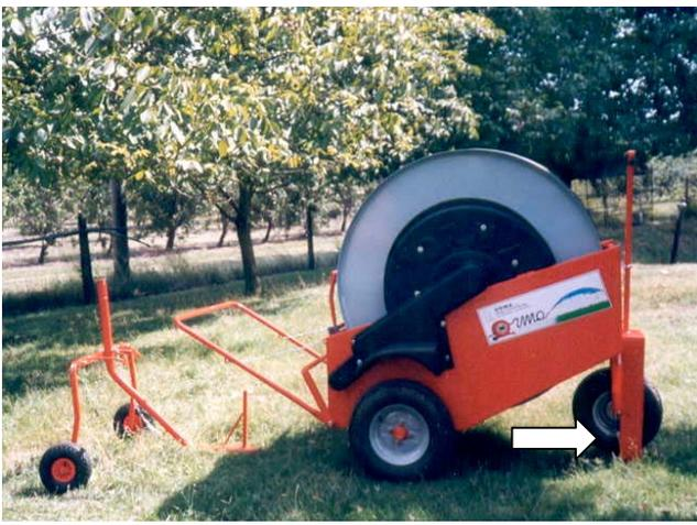
**1.** Posizionare la macchine nella posizione desiderata frontalmente l'area che si vuole irrigare. Assicurarsi che le staffe di ancoraggio del telaio siano piantate fermamente al terreno.
